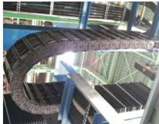
ST095N 적용설비 : 스틸 제조 생산라인 적용국가 : 한국 비 고 : 다양한 스트로크와 구동방향에 적용
